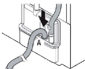
3. Enchufe la manguera de drenaje larga en la salida de la bomba (A) y fíjela. Coloque el otro lado de la manguera en el desagüe del suelo
