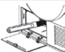
4. Limpie la superficie del intercambiador de calor con un cepillo, y la eficiencia de trabajo de la secadora puede mejorar enormemente después de limpiar la pelusa amontonada.
