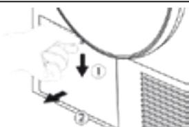
1. Abra la tapa del intercambiador de calor situada debajo de la máquina.
