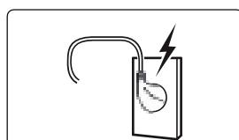
Si el cable de alimentación y el enchufe están dañados o el orificio de la toma de corriente está suelto, deje de utilizarlo inmediatamente y póngase en contacto con un profesional para que lo sustituya.
